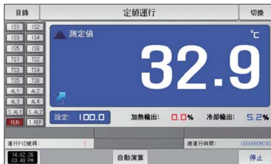
[图3-11]定值运行第1运行画面(加热·冷却)
