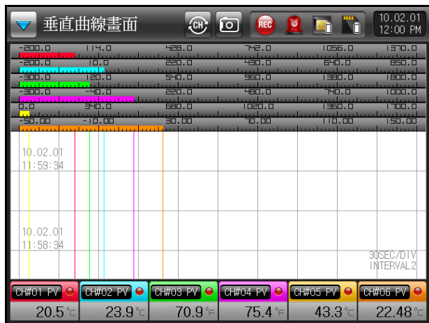
[图片 4-3] PV显示方式设定画面(条形)
